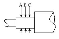
A. SHAFT RADIAL RUNOUT
